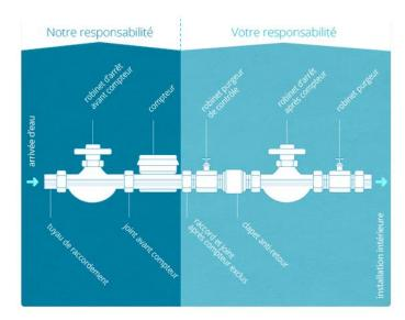
11.2 Le joint après-compteur fait partie de l'installation privée de l'abonné. S'il est posé par la régie EAU RECA, il est garanti un an par elle contre les fuites ou toute autre dégradation ou tout autre vice de fonctionnement, à partir du jour de la pose du compteur. Au bout d'un an, l'entretien et la réparation des joints est à la charge de l'abonné.
